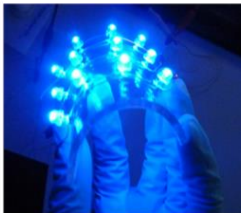
左图：不同银纳米线含量的弹性导电纤维在拉伸测试中电导率变化；右图：利用弹性导电纤维作为导电连接组装的柔性可拉伸 LED 阵列
